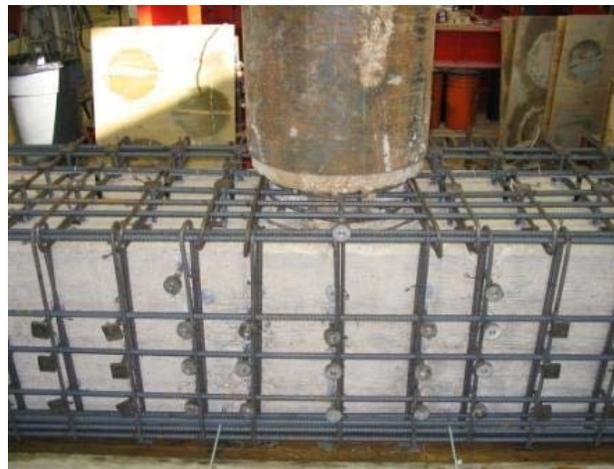
**Figure 0-6. Bent Cap Retrofit Section**
