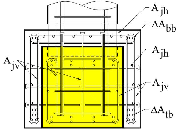
**Figure 0-9. Joint Shear Reinforcements**
