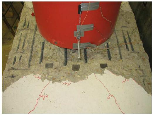
Figure 0-21. Bent Cap Ultimate Damage
