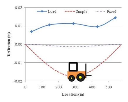
Figure 11.12. HSC Spandrel Beam Deflection – Load Case B.
