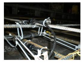
b.) HS-SCC Mild Steel VWSG Arrangement
