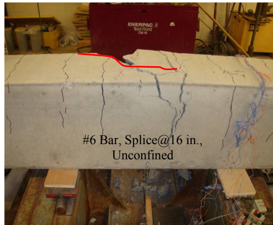
(d) Split failure of B-6-4
